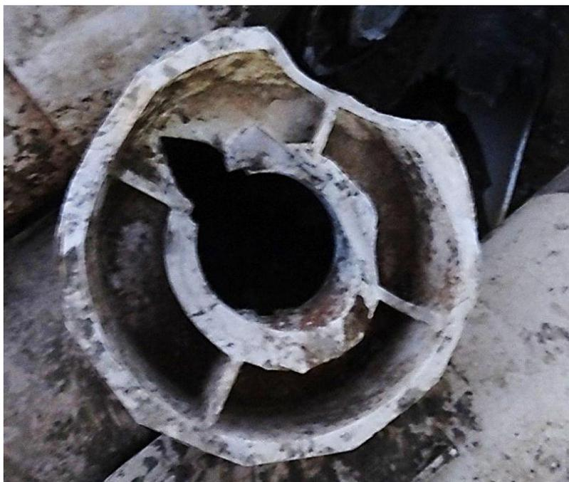
**FOTO 13** Detalle de aireador fracturado, sector Maitencillo. Fuente: INDH
